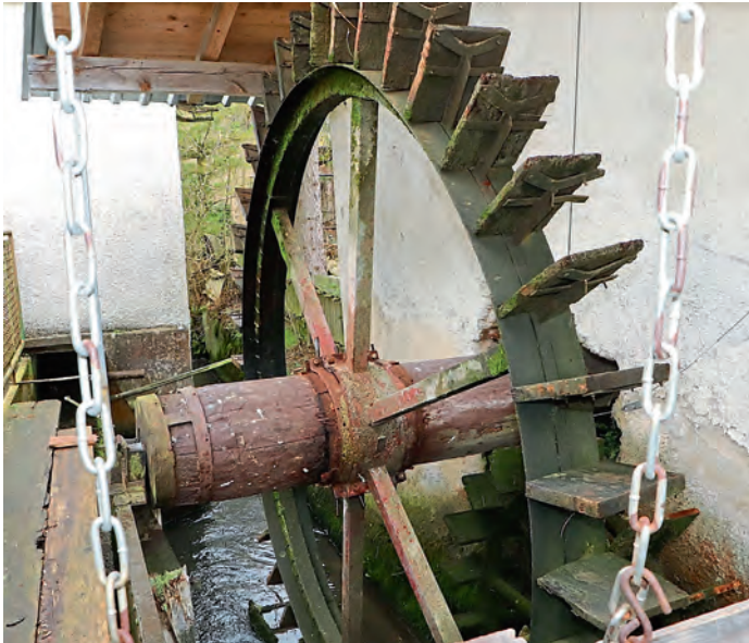
Mit Wasserkraft werden die zwei drei Zentner schweren Schmiedehämmer angetrieben.
